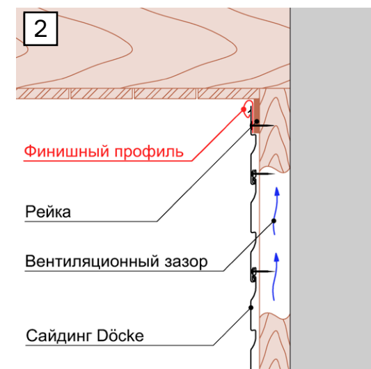
Рис. 25 Примыкание сайдинга Döcke к карнизному свесу при помощи финишного профиля.
