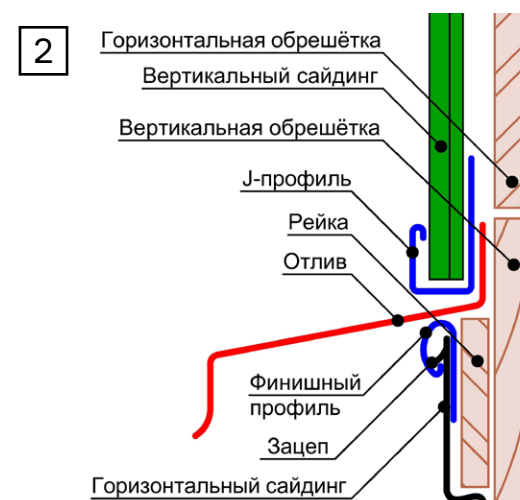
Рис. 32 Стыковка горизонтального сайдинга с вертикальным в случае, когда горизонтальный сайдинг снизу, а вертикальный сверху.
