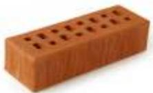
Фасадный клинкерный кирпич предназначен для наружной облицовки стен и отличается повышенной устойчивостью к внешним воздействиям благодаря уникальным показателям прочности ( $M \geq 450$ ) и низкому водопоглощению до 2%, а так же морозостойкости более 100 циклов.
